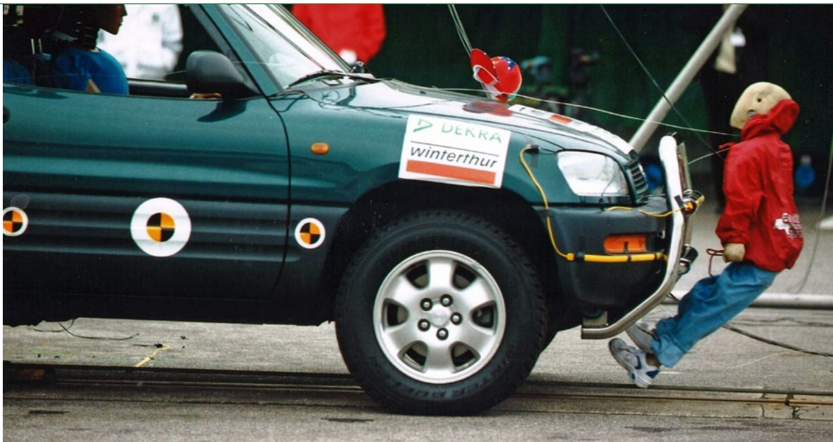
■ En 2000, DEKRA a réalisé un crash test pour déterminer les risques que représentent les pare-buffles et l'avant anguleux des véhicules tout-terrain, en particulier pour les enfants.
